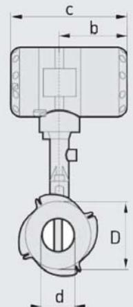
Фланцевая версия, вид сбоку, b = 105 мм, c = 179 мм
