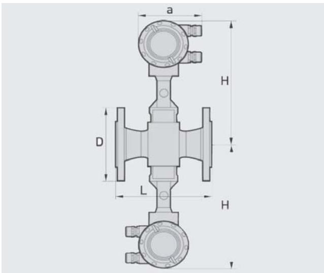
Фланцевая версия, двойной преобразователь, указанный вес + 2.80 кг
