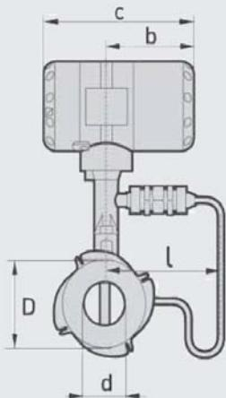
Фланцевая версия, вид сбоку, b = 105 мм, c = 179 мм
