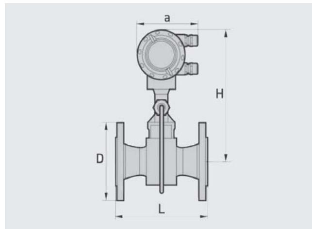
Фланцевая версия, вид спереди, а = 133 мм
