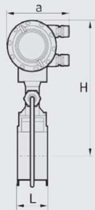
Фланцевая версия, вид спереди, а = 133 мм
