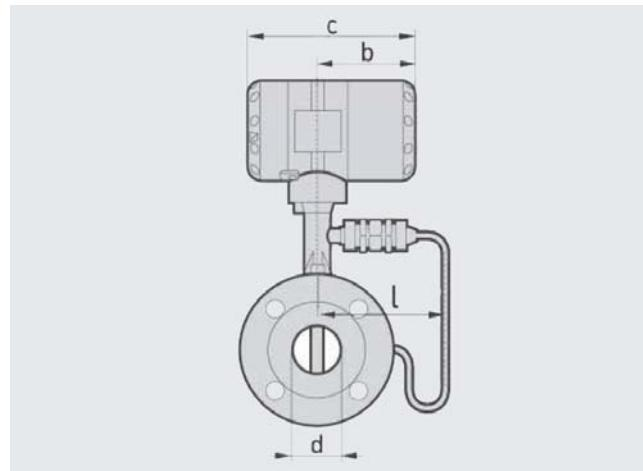
Фланцевая версия, вид сбоку, б = 105 мм, с = 179 мм
